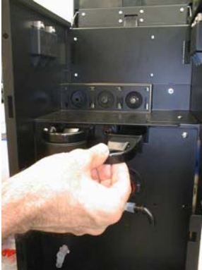
Der untere Schutz entfernen Die Mixerschale entfernen die Ruhrscheibe und die saugenden Schubladen
