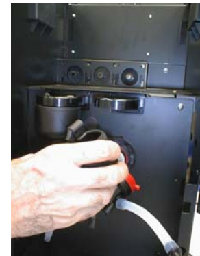
Der untere Schutz entfernen Die Mixerschale entfernen die Ruhrscheibe und die saugenden Schubladen
