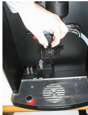
Der untere Schutz entfernen Die Mixerschale entfernen die Ruhrscheibe und die saugenden Schubladen
