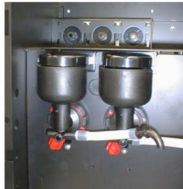
Der untere Schutz entfernen Die Mixerschale entfernen die Ruhrscheibe und die saugenden Schubladen
